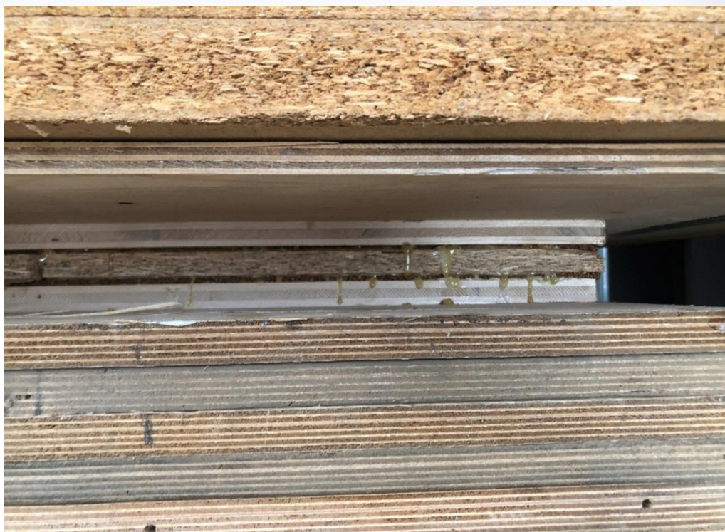
Imagen 1. Aplicación de presión y de calor al conjunto tableros-madera-láminas del MLU para formar el tablero IDSiate 3.
