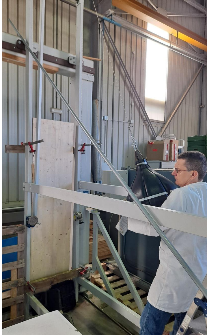
Imagen 13. Ensayo de impacto de cuerpo blando 400 J (50 kg) contra un prototipo no trasdosado.
