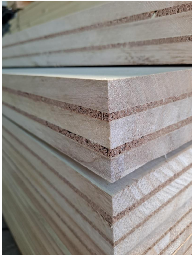
Imagen 3. Vista de detalle de varios tableros IDSiate 2, en la que pueden apreciarse las capas del material lignocelulósico ultra-aislante.
