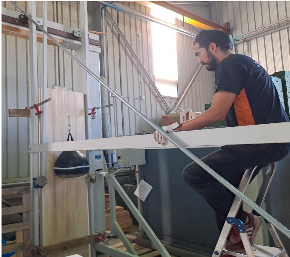
Imagen 14. Momento del impacto del cuerpo blando 400 J (50 kg) contra otro prototipo no trasdosado.
