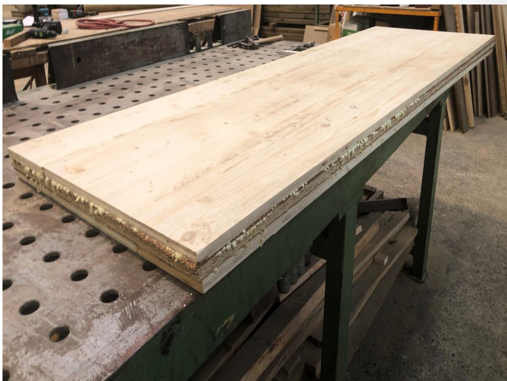
Imagen 2. Un tablero IDSiate 3 recién fabricado, al que faltaba aún aserrar a las dimensiones exactas (2,4x0,6 m).
